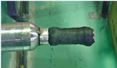
3 先端部スパン シールテープ 取付
